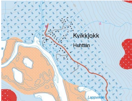
Karta visar aktuella jordarter. Planområdet består av morän (ljusblå) med blockrik till storblockig yta (trekants-symboler). Källa: Kartvisare jordarter, SGU, 2018.
